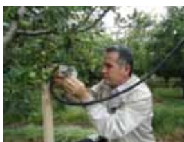
Fig. 2 Matësi elektronik i lagështisë në gjethe
