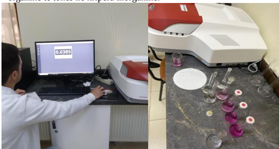
Foto 22. Pamje gjatë procesit të matjes me spektrofotometër të nitriteve në ujë
