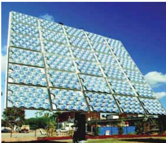
Panel fotovoltaik në plan të lëvizshëm me dy akse
